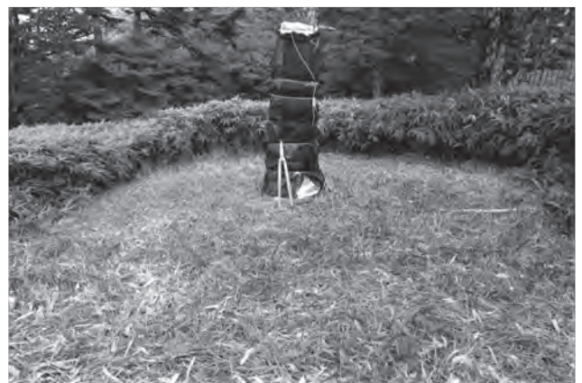
樹液流測定のトウヒ成木周囲のササ刈り 被覆物は日射による樹幹温度上昇の抑制が目的
