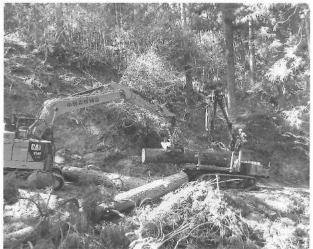
フォワーダへの積み込み作業
