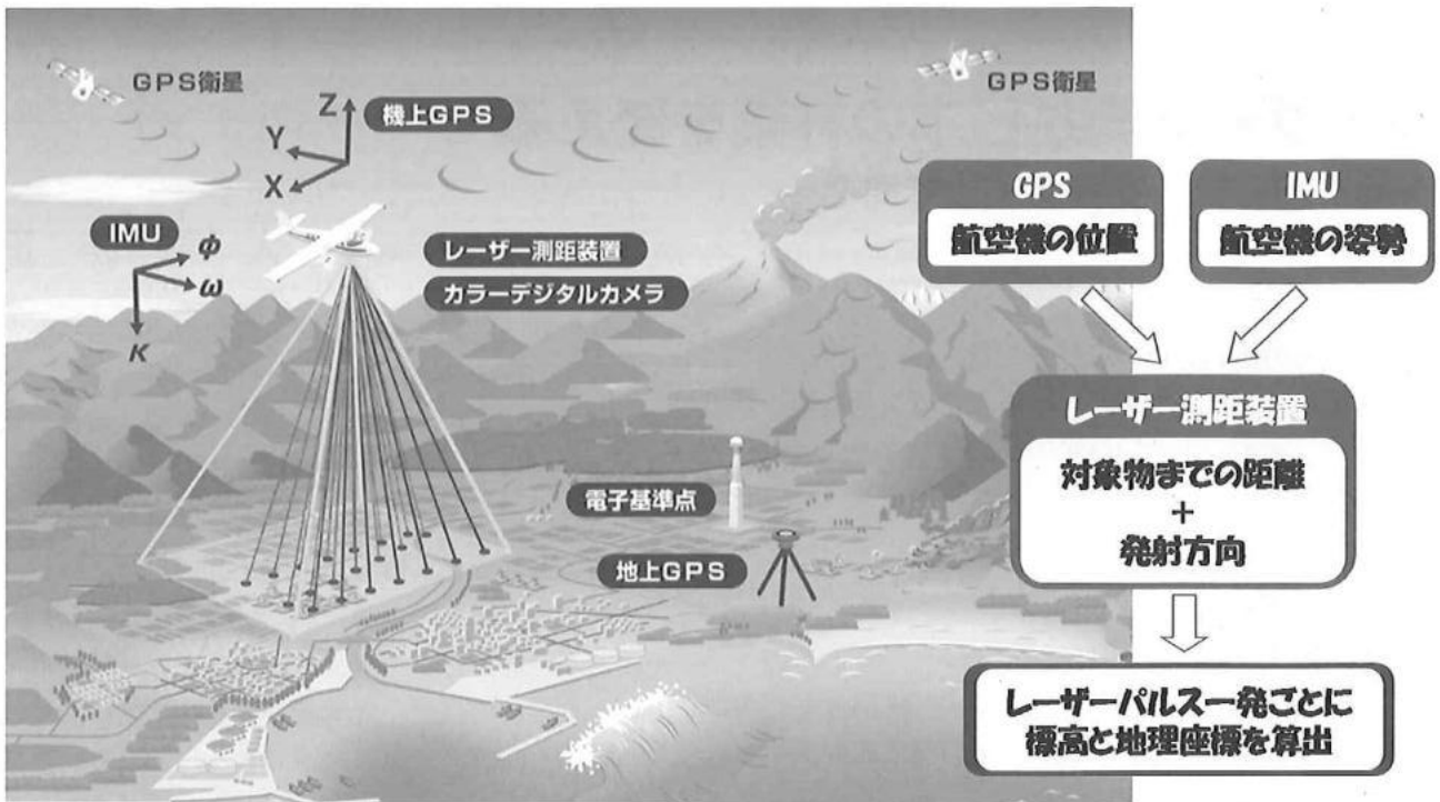
図1 航空レーザー計測の仕組み
