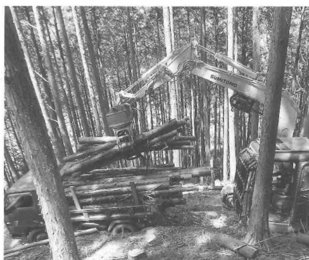
図-2 2tトラックによる集搬作業
