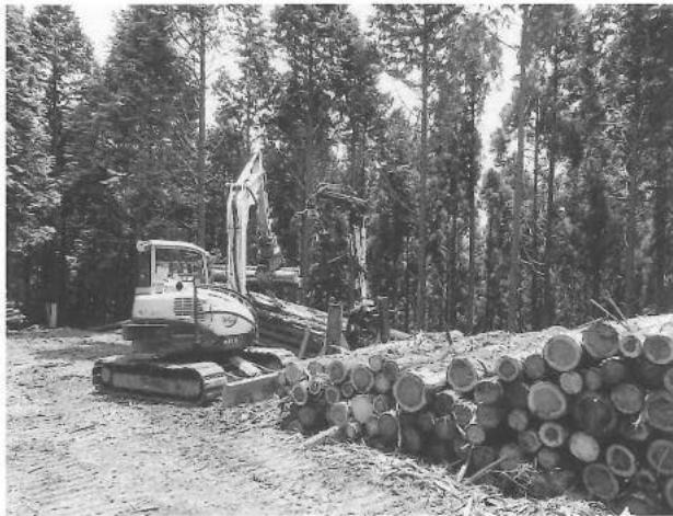
図-3 フォワーダ集搬における山土場での荷下ろし状況
