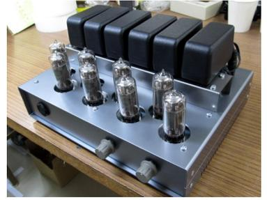
お手軽・ECOな真空管OTLアンプのCIRCLOTRON版を考えてみました。CIRCLOTRONは完全対称回路でスッキリしている一方で、電源が沢山必要なことが不利な点ですが、ACアダプターを使うと簡単に製作できます。オペアンプのおかげで真空管OTLアンプとは思えないほど、良い特性が得られました。
