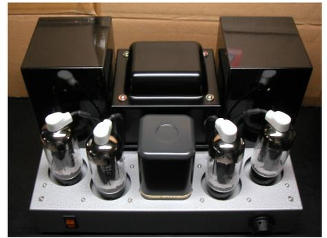
そこで本機では半導体を使った特殊三結回路を試してみました。上図が基本回路ですが、大雑把に言えばプレート - カソード間の抵抗の分圧比で静止時のスクリーングリッド電圧が決まり、スクリーングリッドへ戻す信号も同じ分圧比となりますので、所謂UL比率が100%となり、三結動作と同等になります。本機のオリジナル回路はMJ誌2011年10月号の征矢進氏の製作記事ですが、記事で使われていた三極管をMOSFETに置き換えました。記事では特殊UL接続と書かれていましたが、どう考えても三結に近い動作になりますので、特殊三結と呼び替えています。スクリーングリッド電圧を上げると電流が流れやすくなる( $E_p - I_p$ 特性の傾きが急になる)ので、出力を搾り出そうとする場合はバイアスは深くなりますが、スクリーングリッド電圧を出来るだけ高く設定するのが良いでしょう。(本機は、 $E_p = 385V$ 、 $E_{sg} = 217V$ 、 $E_{g1} = -63V \sim -58V$ 、 $I_p + I_{sg} = 70mA$ 。)
