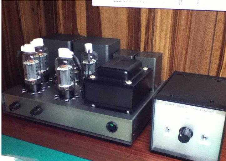
本機は、手作りアンプの関西支部の807大会に出品した25CD6GAアンプと内容は同じです。一次側巻線をトリファイラ巻きにした出力管を使用して、水平偏向出力管をマツキントツシユタイプのカSPPAンプに適合させました。
